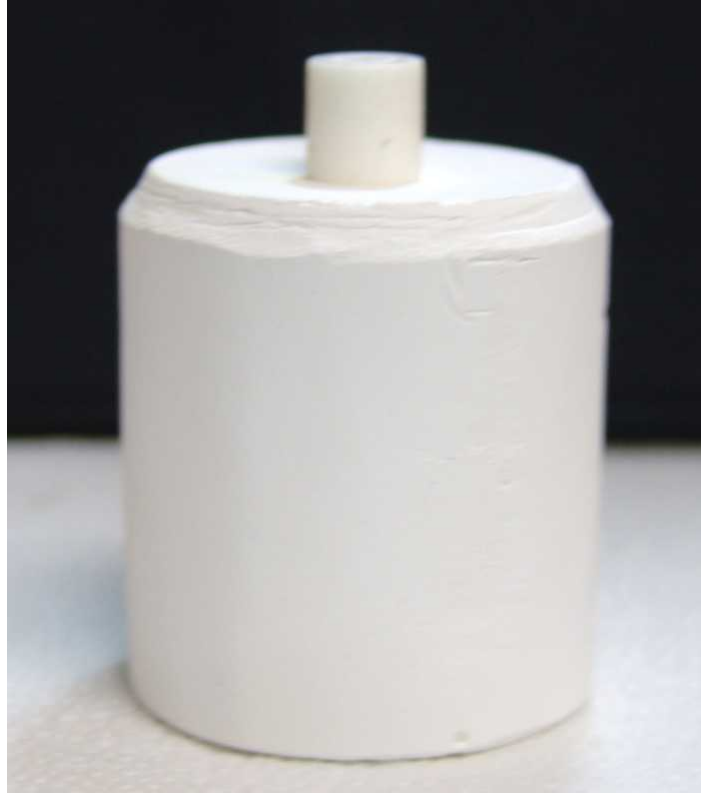
Figura 6 - Cilindro com a cerâmica IPS Empress Esthetic no seu interior.
