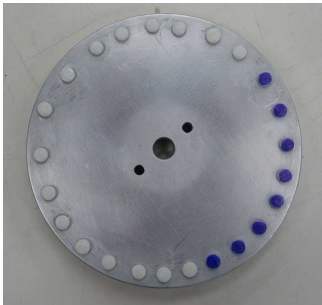
Figura 8 – Dispositivo metálico onde os corpos de prova foram fixados.
